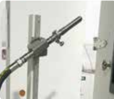
IPX5、IPX6、IPX6K喷射水试验
