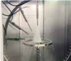
IPX9K高压喷射水试验
